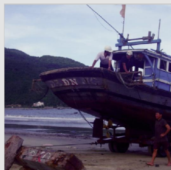
Nhà đa năng tránh bão lụt; Gia cố đê biển; trồng cây ven biển để thích ứng với BĐKH. Hệ thống kéo tàu thuyền lên bờ khi có gió bão tại phường Thọ Quang, quận Sơn Trà, Tp. Đà Nẵng
